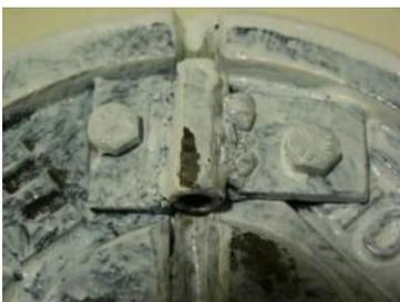
Se suelda una tuerca de mariposa al trozo de varilla roscada, para poder apretar con comodidad el contrapeso a la barra de la montura.
